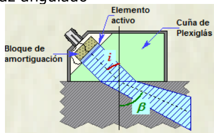
Figura 36. Palpador de haz angulado
