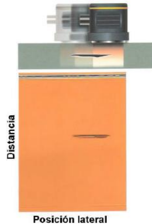
Figura 45. Presentación de datos tipo B-Scan
