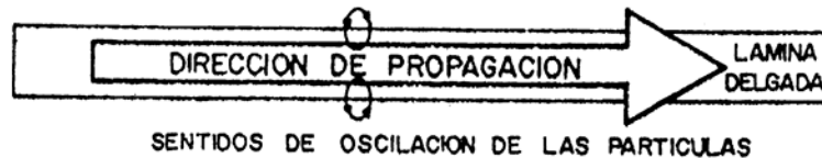
(b) Dirección de propagación y sentido de oscilación de las partículas.
